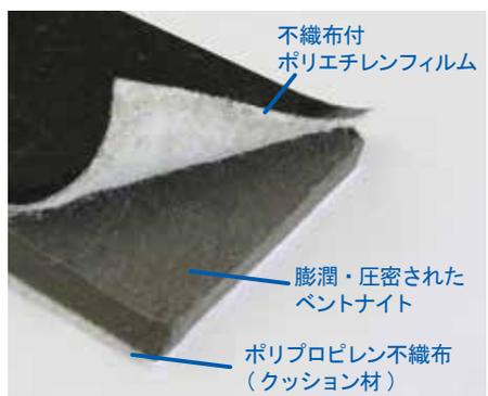
一般的なベントナイトシートは乾燥状態の粘土を現地に持ち込み、土中に敷き込んで粘土の遮水層を形成するための製品です。カルシウムを含有する水などに触れてしまうと膨潤しないか膨潤後に収縮が発生し、健全な遮水層ができません。
