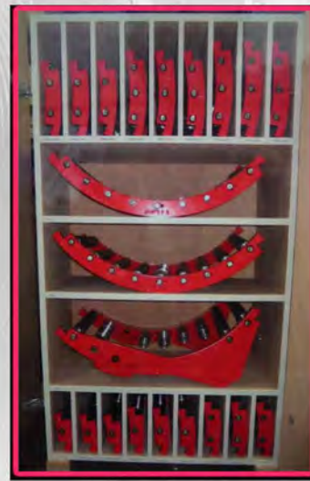
製管ケージ（組立て前の状況）
