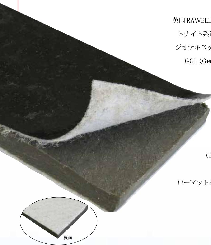
英国 RAWELL ENVIRONMENTAL LTD.は1975年よりベントナイト系遮水材の基礎研究に着手し、ベントナイトをジオテキスタイルで挟み込むシート・マット状の遮水材、GCL (Geosynthetic Clay Liner) を開発してきました。
