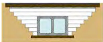
構造物の埋め戻し
